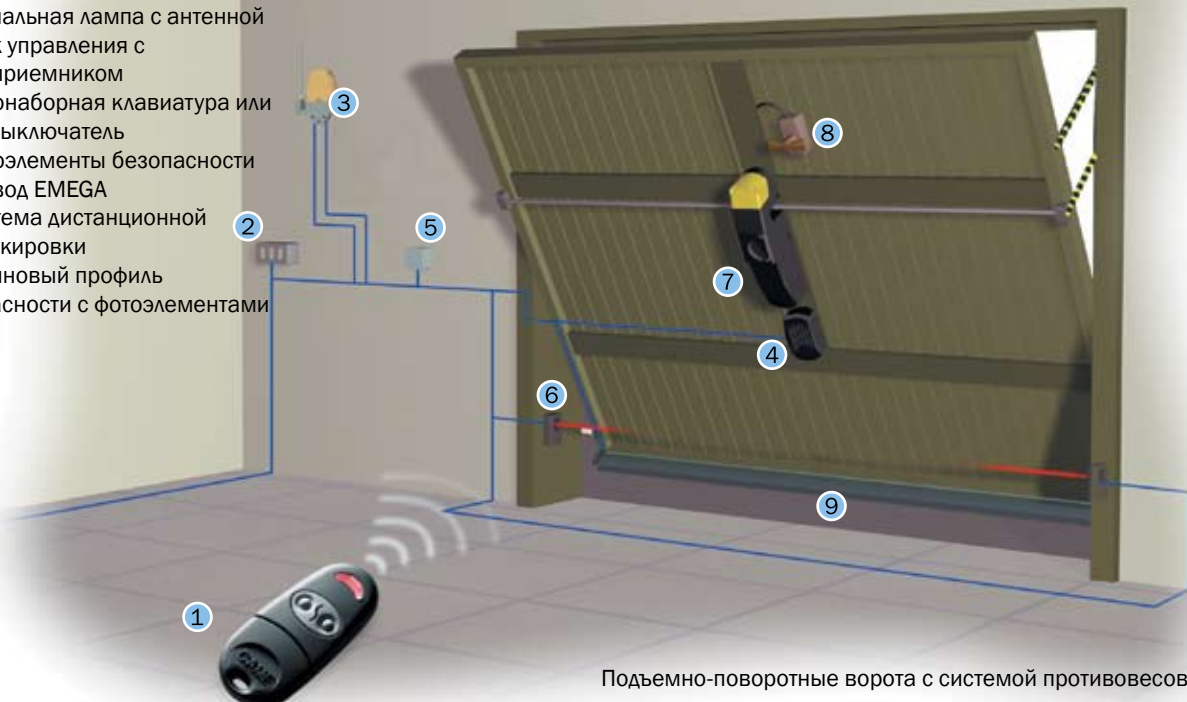
Подъемно-поворотные ворота с противовесами
