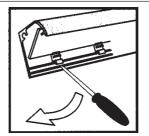
Отключить SLAVE, снять крепление с SLAVE или MASTER, используя отвертку
