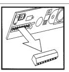
Снять колодку подключения с MASTER
