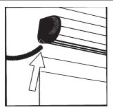
Продеть гофрированную трубку через отверстие в крышке
