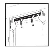
Установить на место переднюю крышку профиля: установить крышку в верхние направляющие; постепенно защелкнуть крышку в профиль
