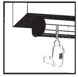
Просверлить два отверстия диаметром 4.5 мм в задней стенке алюминиевого профиля и в дверной створке.
