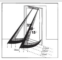
Зона обнаружения радара в зависимости от угла наклона модуля.
