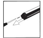
Открутить винты и снять боковые крышки
