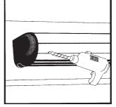
Вырезать часть крышки со стороны дверных петельдля гофрированной трубки. Установить и закрепить крышку со стороны дверных петель. Просверлить два отверстия диаметром 4.5 мм в задней стенке алюминиевого профиля и в дверной створке.
