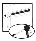
Закрепить накладку для фиксации кабеля на стене.
