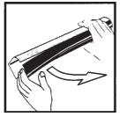
Снять переднюю крышку
