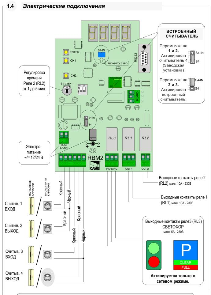
ДАЛЕЕ В ИНСТРУКЦИИ ДАНО ОПИСАНИЕ ПРОГРАММИРОВАНИЯ RBM2 В АВТОНОМНОМ РЕЖИМЕ РАБОТЫ С ПОМОЩЬЮ ПРОКСИМИТИ СЧИТЫВАТЕЛЕЙ. В СЛУЧАЕ ИСПОЛЬЗОВАНИЯ СЧИТЫВАТЕЛЕЙ МАГНИТНЫХ КАРТ, НЕОБХОДИМО В ИНСТРУКЦИИ СЛОВА "ПОДНЕСТИ КАРТОЧКУ К СЧИТЫВАТЕЛЮ" ЗАМЕНИТЬ НА "ПРОВЕСТИ КАРТОЧКОЙ ПО ОТВЕРСТИЮ СЧИТЫВАТЕЛЯ". ДЛЯ РАБОТЫ СИСТЕМЫ В СЕТЕВОМ РЕЖИМЕ НЕОБХОДИМО УСТАНОВИТЬ ПРОГРАММНОЕ ОБЕСПЕЧЕНИЕ САМЕ. ИНСТРУКЦИЯ ПО ПРОГРАММИРОВАНИЮ И РАБОТЕ СИСТЕМЫ В СЕТЕВОМ РЕЖИМЕ ВЫСЫЛАЕТСЯ В КОМПЛЕКТЕ С ПО.
